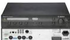
Микширующий усилитель 60Вт – 1 alarm-вход 0 дБ или 100В – 2 приоритетных микрофонных / линейных входа: 1 сухой контакт (евро разъем или XLR) и 1 VOX (XLR), 2 микрофонных / линейных входа (XLR), 3 линейных входа (RCA), 1 разъем RJ45 вход для проигрывателей PLE-WP3S2Z – 1 выход 0 дБ (XLR) – 1 выход 80м или 100В – 230В или 24В (зарядное устройство 1А) – Поставляется с монтажными кронштейнами в 19" стойку – 2U
