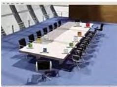
Пакет программного обеспечения для управления конференц-системой DCN NG – Синоптический обзор помещения для отслеживания и управления микрофонами – Вставка изображения зала (BMP, JPEG) – Возможность связать значок динамика на изображении с устройством – Управление электронным голосованием – Отображение онлайн результатов голосования с помощью инструментов PowerPoint – Файлы справки
