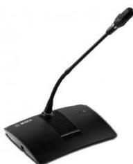
Пульт делегата/председателя – Встроенный громкоговоритель – Микрофон на длинной ножке 478 мм – Два 3,5мм стереоразъема для наушников или индуктивных нашейных устройств для людей с нарушениями слуха (HDP-ILN) – 2 кнопки для регулировки уровня громкости наушников – Выходная мощность 2 x 15 мВт/32 Ом – Длина кабеля 2 м – Частотная характеристика от 30 Гц до 20 кГц
