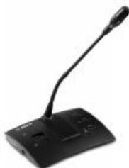
Пульт делегата/председателя с переключателем каналов и функцией голосования – Встроенный громкоговоритель – Встроенный микрофон и разъем для микрофона – Два 3,5мм стереоразъема для наушников или индуктивных нашейных устройств для людей с нарушениями слуха (HDP-ILN) – 2 кнопки для регулировки уровня громкости наушников – Выходная мощность 2 x 15 мВт/32 Ом – Длина кабеля 2 м – Частотная характеристика от 30 Гц до 20 кГц
