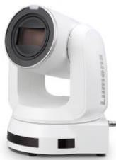
Поворотная IP камера 4K для конференций, 30x оптический zoom, 1/1,8", интерфейсы HDMI, Ethernet, 12G SDI, поддержка протокола потоковой передачи RTSP / RTMP / RTMPS / MPEG-TS / SRT, белого цвета
