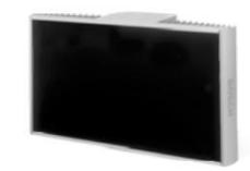
Цифровой инфракрасный излучатель 12,5Вт – Совместимость с 32 каналами – Выбор переключения передачи мощности (100% или 50%) – Светодиоды (активный, в режиме ожидания, неисправность) – 2 BNC разъема (вход / выход, 75Ω коаксиального кабеля) – Два переключателя компенсации задержки для компенсации различий в длине кабелей между передатчиком и излучателями – Регулировка угла наклона излучателя – Для настенного монтажа, на потолке или штативе
