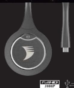
**Аппаратный ключ вещания USB-C для устройств Apollo и презентационных коммутаторов**
