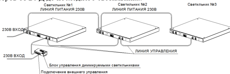
Рисунок 5. Пример подключения 3 светильников в одну линию
