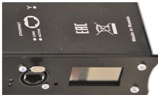
При «зависании» системы блока можно воспользоваться аппаратным сбросом. Кнопка утоплена за переднюю панель (расположена слева от дисплея). Острым предметом нажмите на кнопку, произойдет перезагрузка блока.
