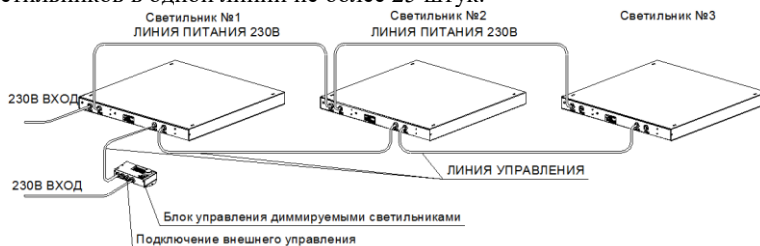
Рисунок 7. Пример подключения 3 светильников в одну линию
